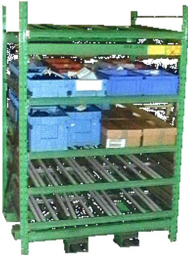
Das Lager sollte entsprechend den im Kreislauf eingesetzten Behältergrößen konzipiert sein und muß FIFO (first in - first out) ermöglichen.
